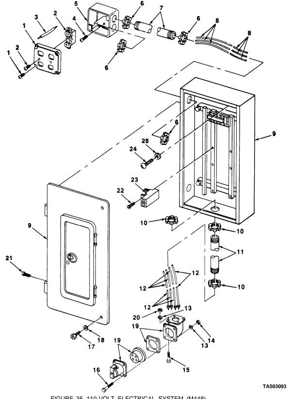
FIGURE 35. 110-VOLT ELECTRICAL SYSTEM (M448).
