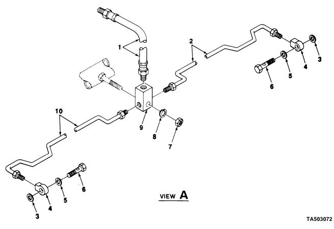
FIGURE 14, VACUUM HYDRAULIC BRAKE SYSTEM HOSES, LINES AND FITTINGS (M105A2C).
