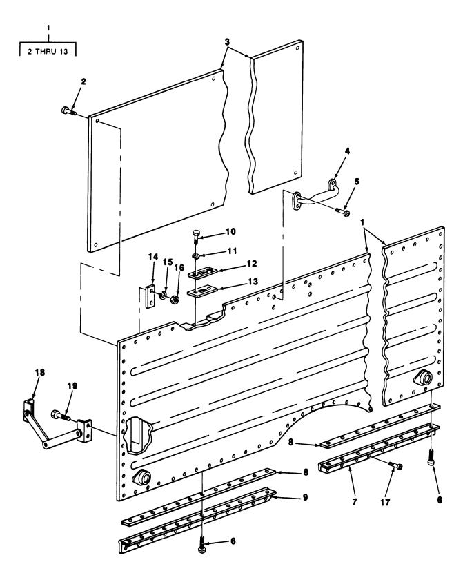
FIGURE 38. VAN BODY DOOR ASSEMBLY (M448).
