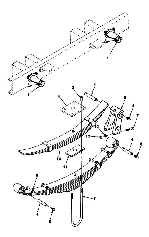
FIGURE 28. MAIN AND AUXILIARY SPRINGS.
