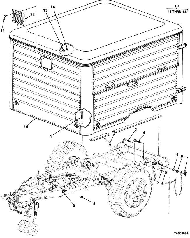
FIGURE 36. VAN BODY ATTACHING HARDWARE (M448).
