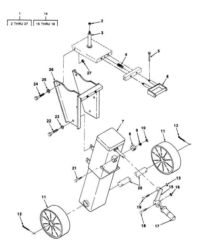
FIGURE 26. ADJUSTABLE CASTER ASSEMBLY.
