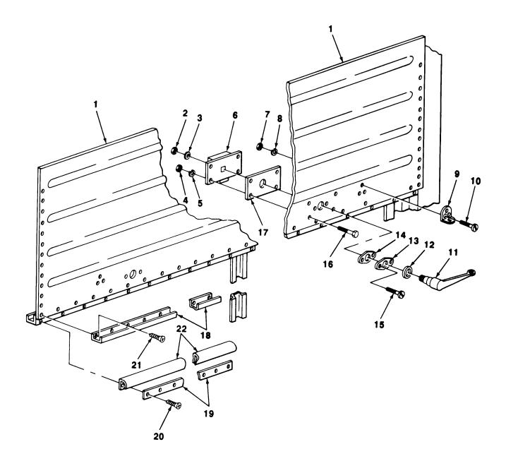
FIGURE 39. VAN BODY SIDE ASSEMBLY (M448).
