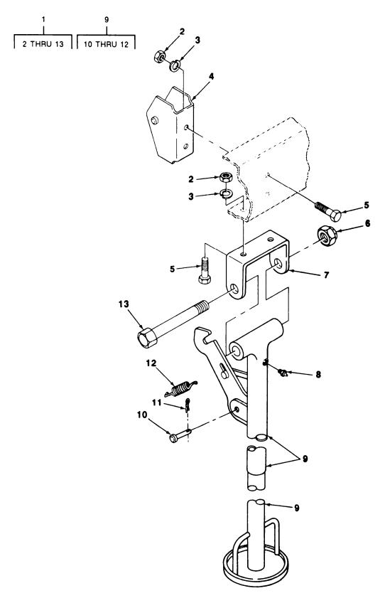
FIGURE 25. SUPPORT LEG (M105A1, M105A2).
