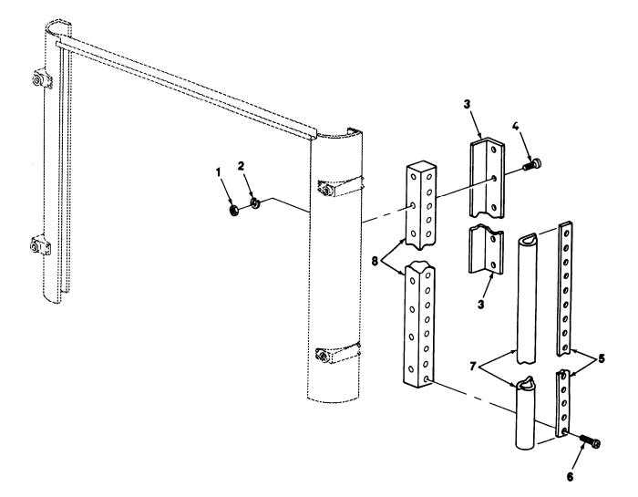
FIGURE 37. VAN BODY REAR DOOR SEAL ASSEMBLY (M448)
