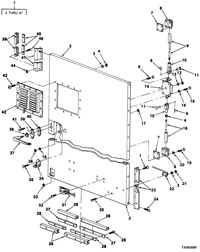
FIGURE 41. VAN BODY RIGHT DOOR ASSEMBLY (M448).
