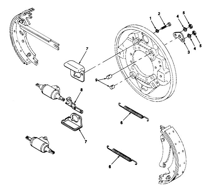
FIGURE 10. BRAKE RELATED COMPONENTS (M103A3, M105A2, M105A2C, M107A2, M107A2C, M448).
